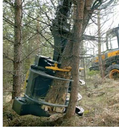
Ponsse EH25-energiapuukouralla voi kerätä useita puuta yhtäaikaaisesti. Vahva giljotiini-terä leikkaa jopa 30 cm paksuja runkoja.
